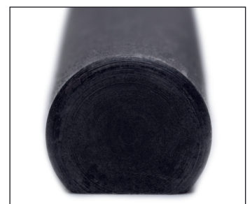
Der Schaft ist unten abgerundet, damit man das Werkzeug frei bewegen kann, und trotzdem sicher auf der Messerauflage liegt.
